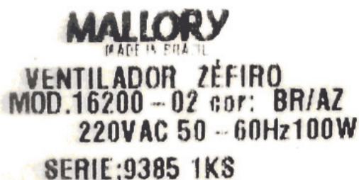
Figura 7.4: Adesivo com informações elétricas de um ventilador onde é possível ver o valor da potência, sua voltagem, o tipo da corrente.
