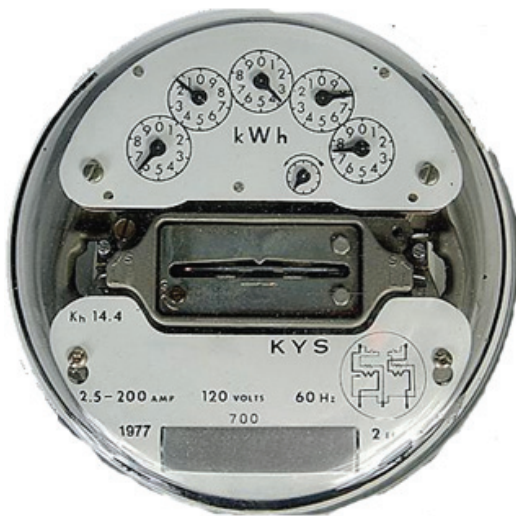
Figura 7.1: Relógio de luz usado para medição do consumo de energia elétrica de uma residência
