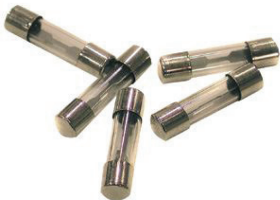
Figura 7.10: Imagem de vários fusíveis. Perceba que no interior do vidro há uma lâmina metálica. Sob o efeito de alta corrente, a lâmina aquece, derrete e abre, protegendo o circuito.
