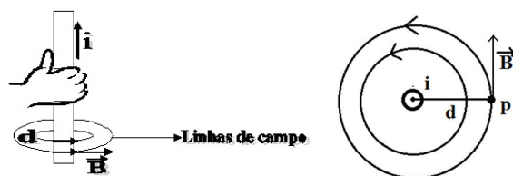
Figura 2.1: fio sendo percorrido por uma corrente elétrica i gerando um campo magnético circular centrado no fio em um plano perpendicular a este com vetor indução magnética \vec{B} no ponto p .
