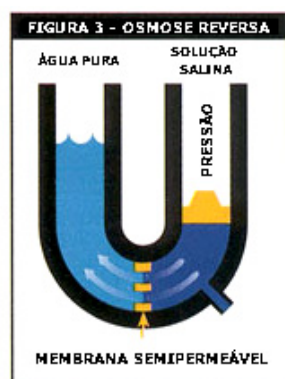
Figura 13 - Esquema mostrando o processo de osmose reversa. Fonte: http://www.waterworks.com.br/osmosereversa_tecnologia.html
